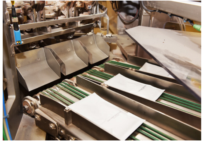
Defekte Pakete werden mit einem Schiebelukensystem vom Band abgeworfen
