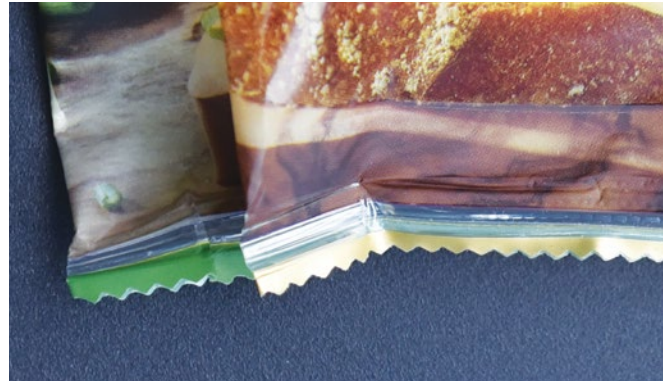
Emballage rejeté avec un pli dans la soudure.
