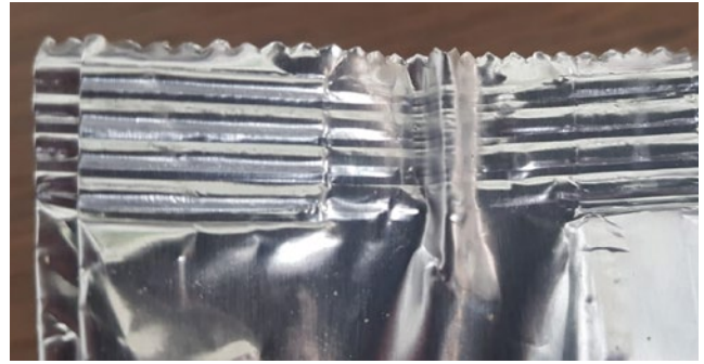
Sachet avec plis indésirables rejeté par le système SealScope
