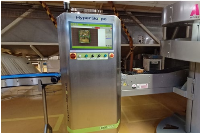
Kelly verfügt über zwei vollautomatische Verpackungslinien mit HyperScope® Inline-Siegelnahtkontrolle
