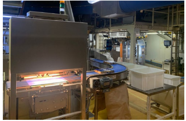
Kelly verfügt über zwei vollautomatische Verpackungslinien mit HyperScope® Inline-Siegelnahtkontrolle
