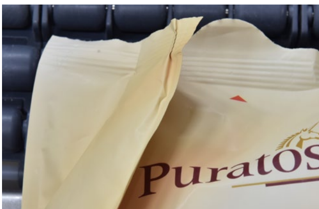
Beanstandete Auswerfung aufgrund von Falten in der Siegelnaht
