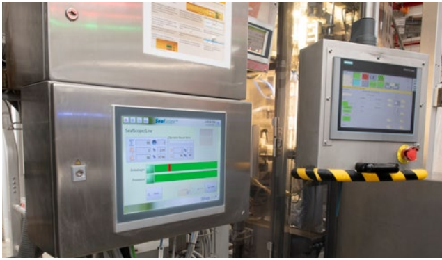
Le système SealScope ® est intégré dans la machine UVA VFFS et ne nécessite aucun espace supplémentaire dans la ligne d'emballage.
