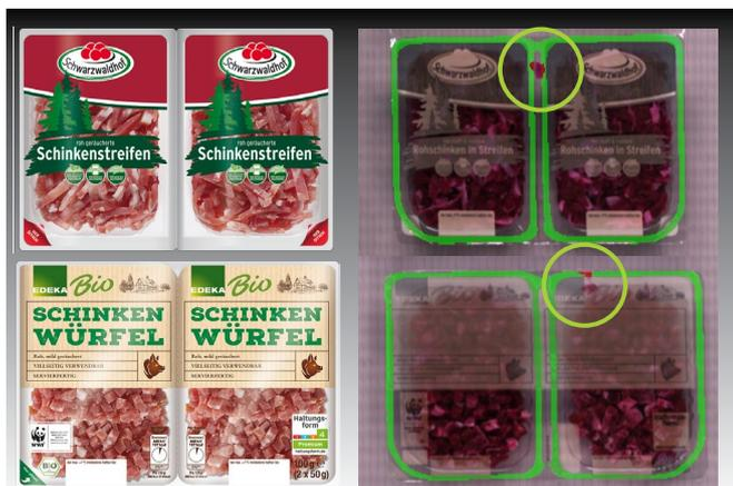
Différents problèmes de scellage : *HyperScope*® est parfaitement adaptée pour détecter les problèmes de scellage dans le tunnel entre deux compartiments.
