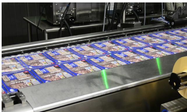
Dans la thermoformeuse MULTIVAC, les barquettes sont remplies de lardons et scellées sous atmosphère modifiée.
