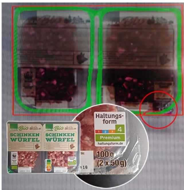
Barquette à deux compartiments avec une soudure défectueuse (voir détail).
