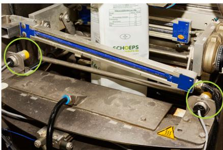
Die Sensoren werden an den Siegelbacken der Verpackungsmaschine montiert
