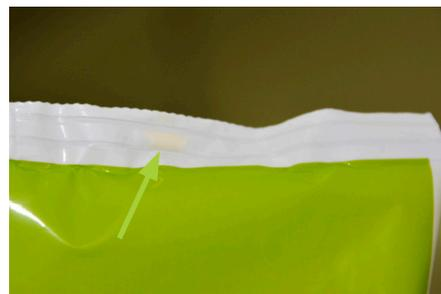
Käsestücke in einer Siegelnaht, die von **SealScope™** aussortiert wurde
