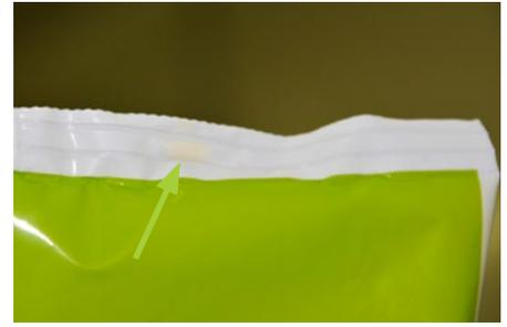
Emballage rejetée par **SealScope**® avec des particules de fromage dans la soudure
