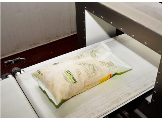
Outre l'inspection des soudures, la détection des métaux est l'un des contrôles de qualité.
