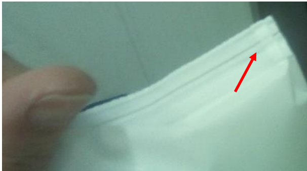
Les plis dans la soudure peuvent entraîner des micro-fuites dans l'emballage
