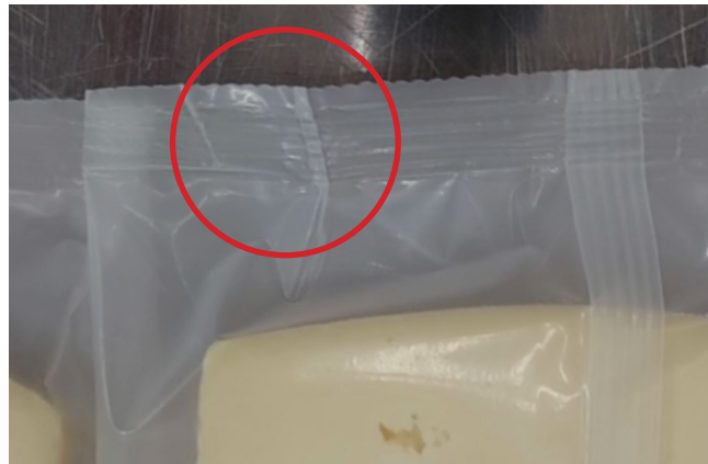
Da die Keile am Ende der Verpackung dicker sind, kann es zu Falten in der Versiegelung kommen.
