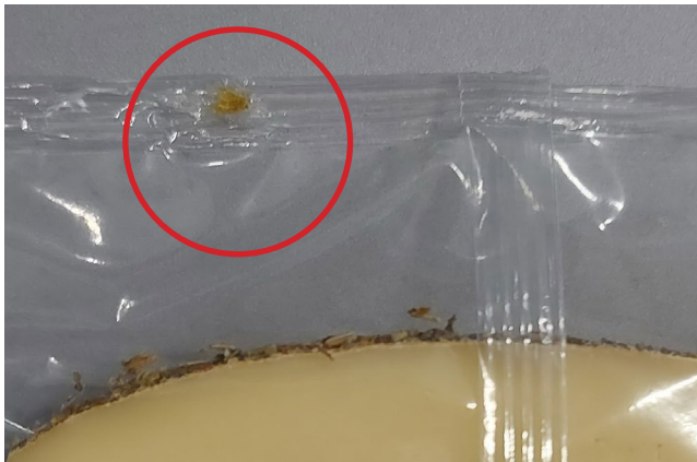
Verunreinigung des Siegelnahts
