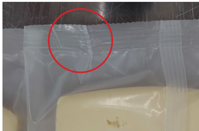
Comme les portions de fromage sont plus épaisses à l'extrémité de l'emballage, des plis peuvent apparaître dans le scellage.
