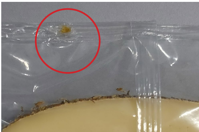
Contamination du scellage avec produit
