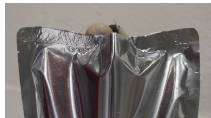
Aussortierter Beutel, bedingt durch Produkteinschluss in der Naht
