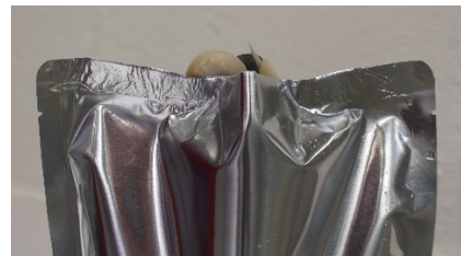
Poche écartée à cause de présence de produit dans la soudure
