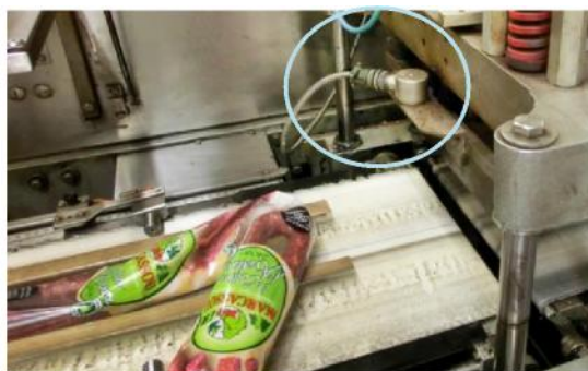
Capteur de vibrations sur mâchoire de soudure
